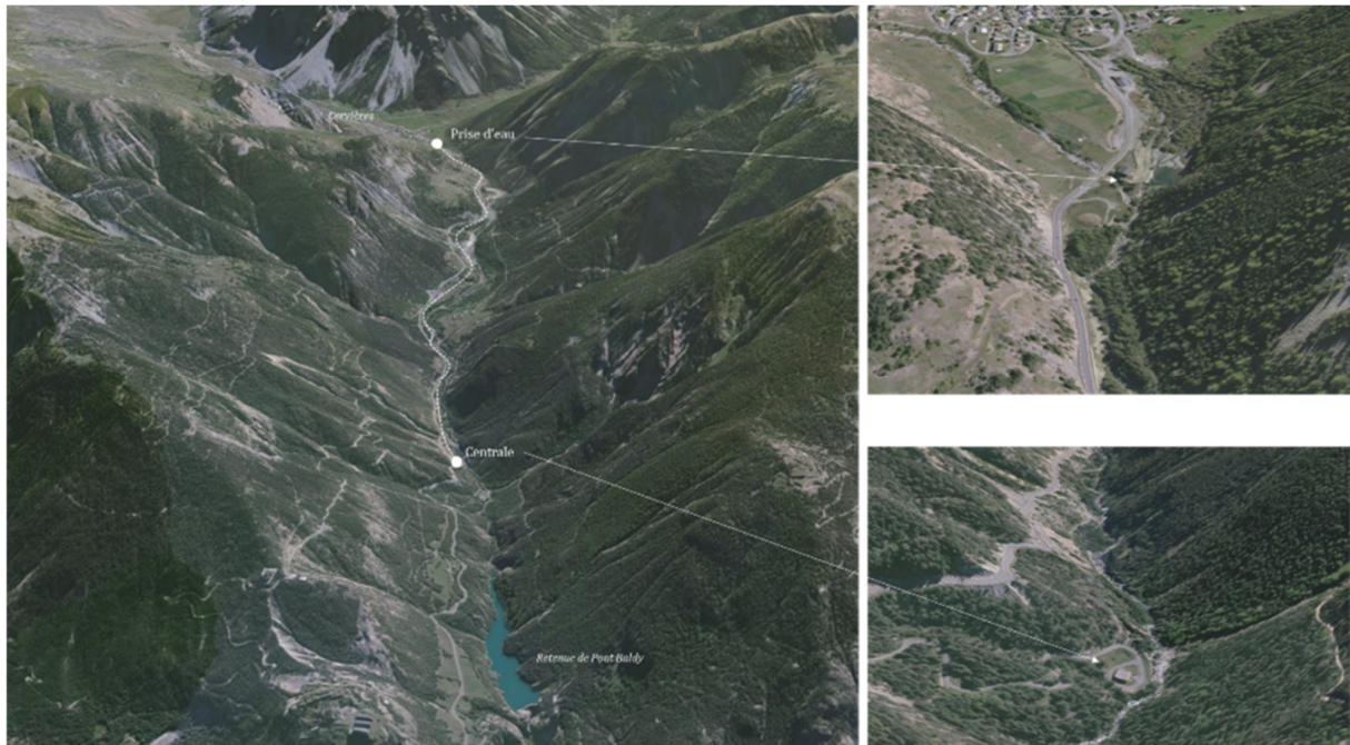
Figure 8 - Cheminement global de la conduite forcée
