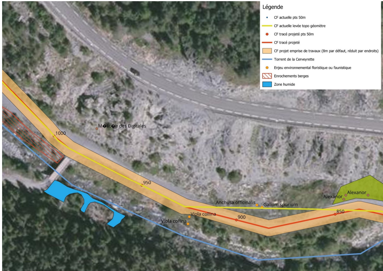
Figure 34 - CF projetée tronçon 4 de 850 à 1000 m
