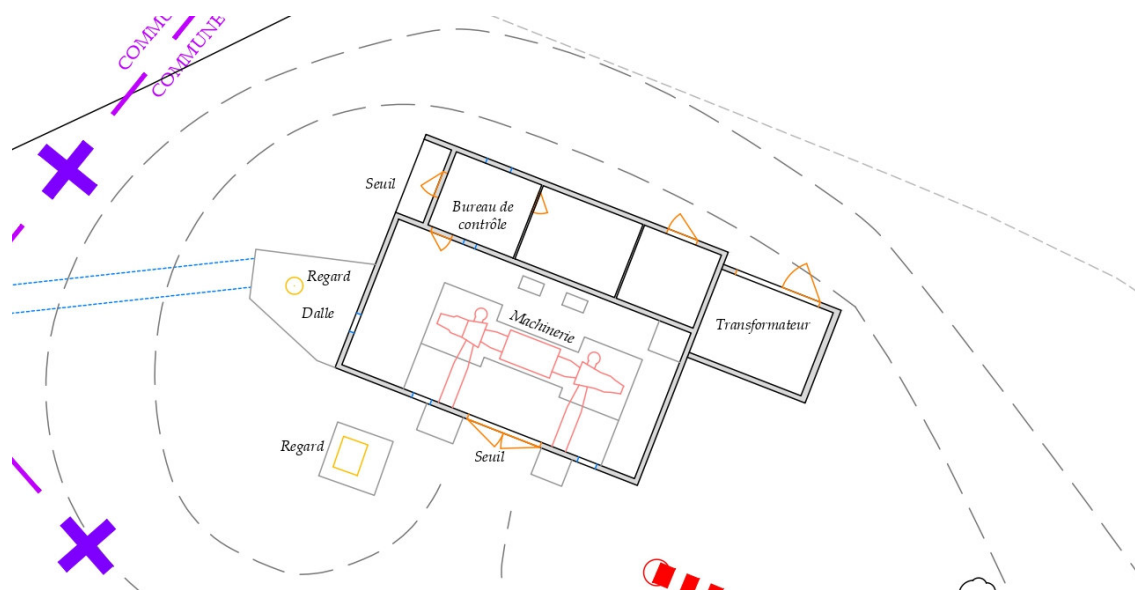
Figure 54 - Vue en plan du bâtiment de l'usine
